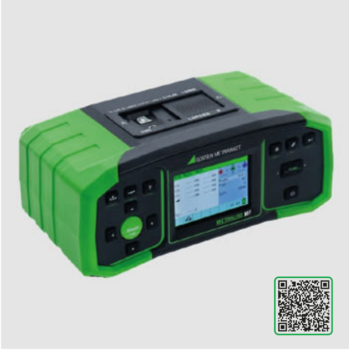
Gossen Metrawatt Metraline MF Çok Fonksiyonlu Tesisat Test Cihazı (M520F) Çevrim ve hat empedansı, süreklilik ve RCD testleri, izolasyon ve topraklama (3 ve 4 telli) testleri Renkli ekran, hafıza ve bilgisayar yazılımı dahil
